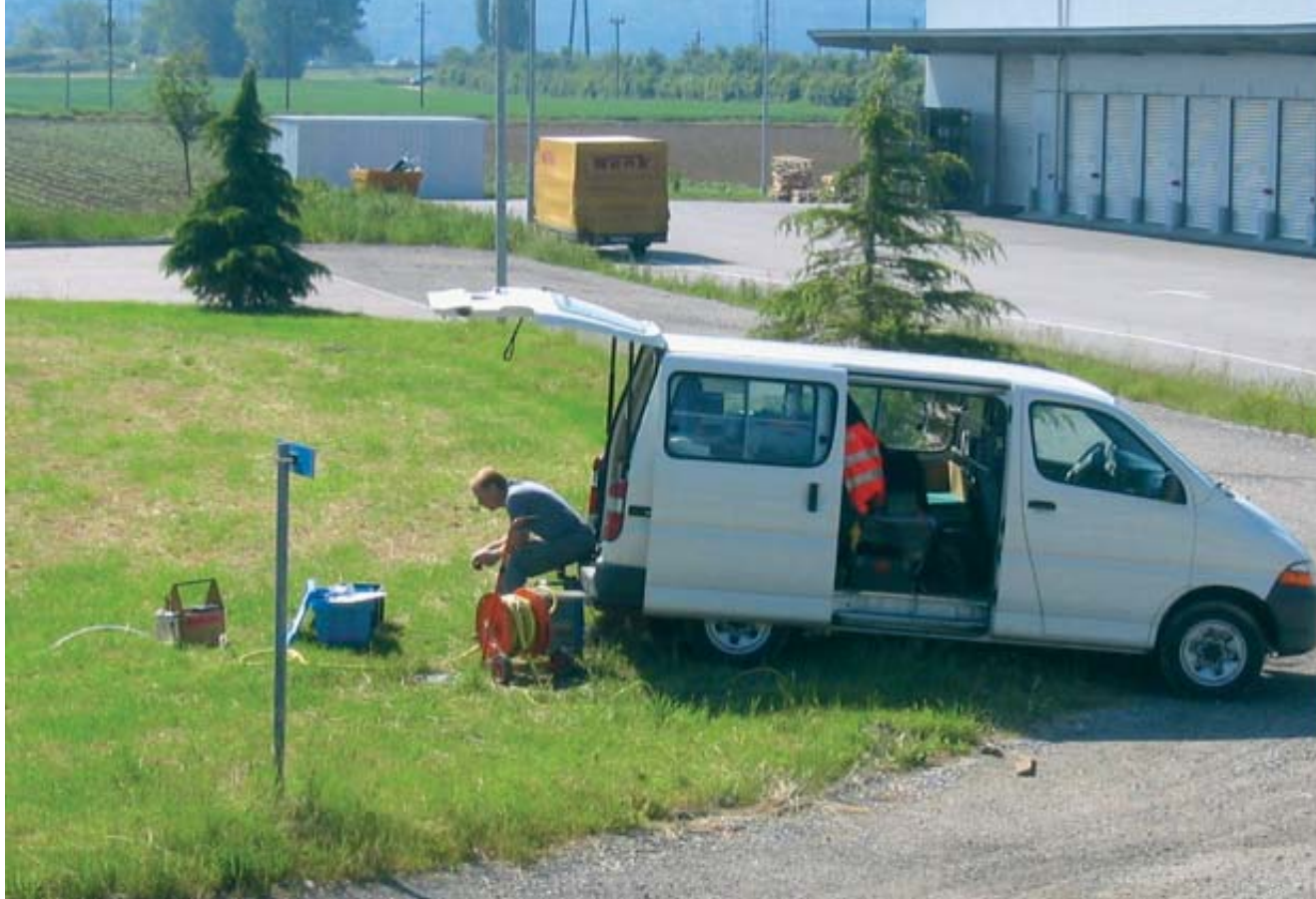
Entnahme von GW-Proben während Bau.
