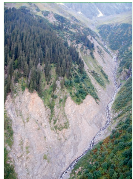
Abbildung 8: Frontaler Bereich der Rutschung Rotloui: Die Rutschmasse stösst in den Rotloui-graben (rechts) und weist im frontalen Bereich eine starke Zerreissung auf (blaue Pfeile) – die grossen Pakete können sich als plötzlich auftretende Sekundärrutschungen ausbilden. Die Hauptablösung ist mit den roten Pfeilen markiert (Fotos C. Kämpfer).
