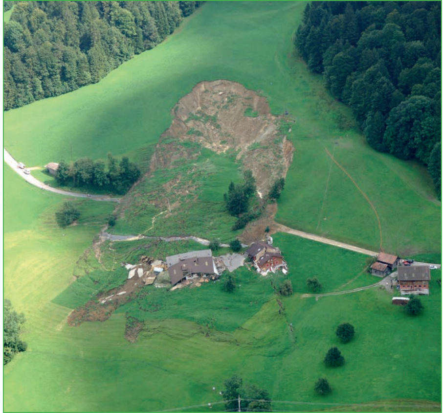
Abbildung 4: Grosse, spontane Rutschung Feldweid: Spontanes Abgleiten eines Hanges nach den langanhaltenden und intensiven Niederschlägen im Sommer 2005 (Foto: Schweizer Luftwaffe).
