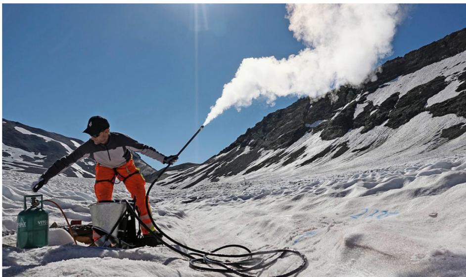
Eisbohren mit Effizienz: Geophysiker Christian Kienholz (Geotest AG, Zollikofen) stösst mit dem Dampfbohrer in Tiefen bis zu 20 Meter unter der Gletscheroberfläche vor.
