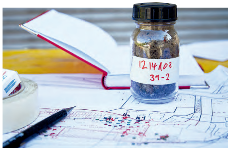
Bodenprobe, welche aus einer Sondierung entnommen wurde und die für eine Schadstoffanalyse in einem Speziallabor chemisch untersucht wird.
