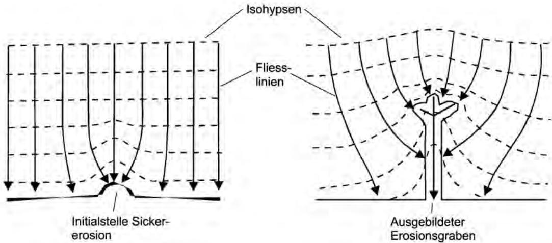
**Fig. 11:** Verlauf der Sickerwasser-Fließlinien und der Isohypsen im Falle von beginnender (links) und fortgeschrittener (rechts) Sickererosion im Bereich eines Erosionsgrabens (nach Crosta & di Prisco 1999).
